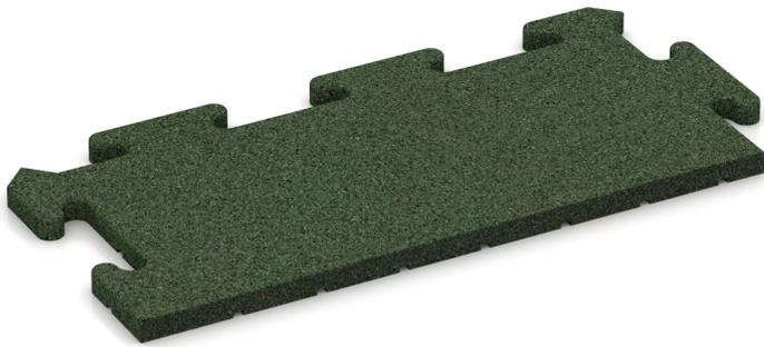
Die Randplatte ist eine halbierte ganzen Platte mit einer geraden Außenkante. Das Verlegen von Randplatten spart Zeit und Geld, wenn die Größe der Plattenfläche durch das Verlegemaß der Platten bestimmt wird. Dann entfällt der Zuschnitt vor Ort und die Plattenfläche ist durch einen Rahmen aus halbformatigen Platten eingerahmt. Die Rand-Abschlussplatte wird zusammen mit der Eck-Abschlussplatte verwendet.
