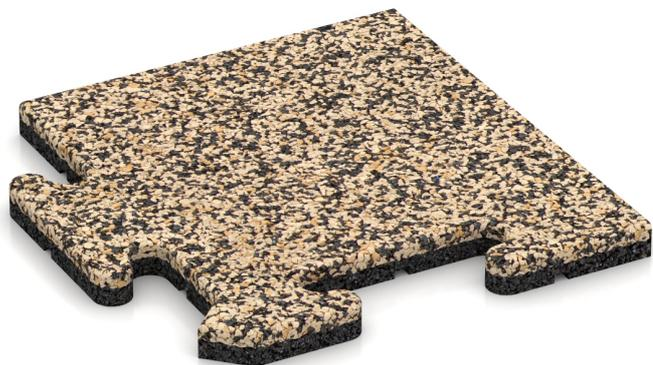
Die Eckplatte ist ein Viertel einer ganzen Platte mit gerader Außenkante an 2 Seiten. Das Verlegen von Eckplatten spart Zeit und Geld, wenn die Größe der Plattenfläche durch das Verlegemaß der Platten bestimmt wird. Dann entfällt der Zuschnitt vor Ort und die Plattenfläche ist durch einen Rahmen aus halbformatigen Platten eingerahmt. Die Eck-Abschlussplatte wird zusammen mit der Rand-Abschlussplatte verwendet.
